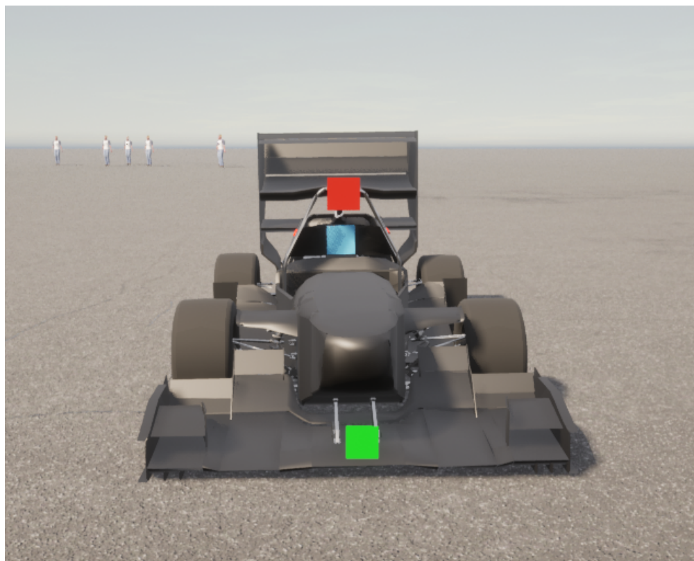
Obrázek 4.4: Umístění LiDARu (zelený čtverec) a kamery (červený čtverec) na monopostu
