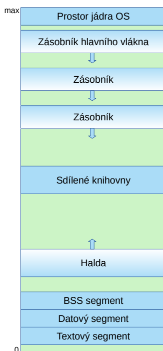
■ Obrázek 2.2 Ukázka virtuálního paměťového prostoru procesu se třemi vlákny. Inspirováno ilustracemi z [2].
