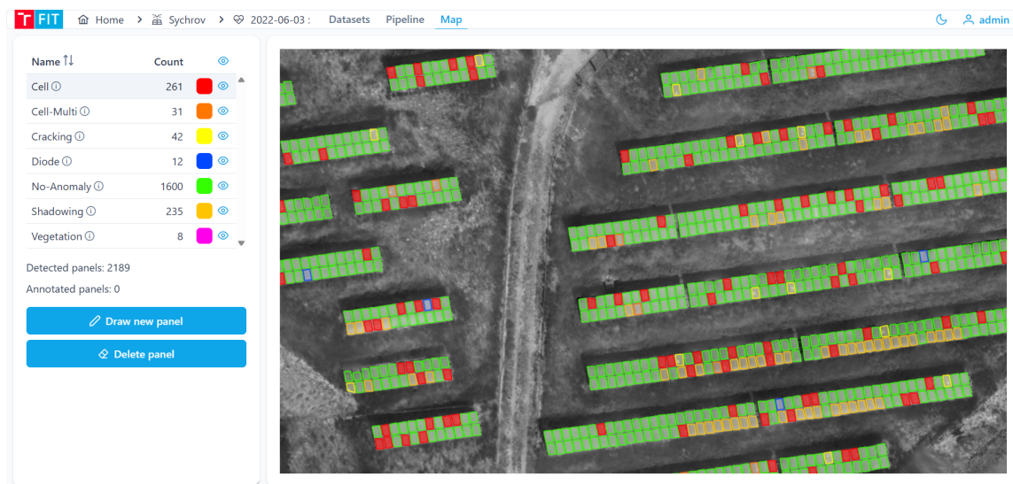
Obrázek 4.12: Ukázka zobrazení výsledků klasifikace panelů.
