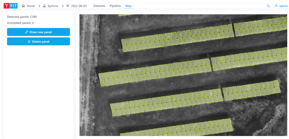
Obrázek 4.9: Ukázka zobrazení ortofota se segmentovanými panely.
