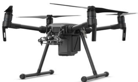
Obrázek 2.6: Dron DJI Matrice 200, který je využíván k inspekci fotovoltaických elektráren.
