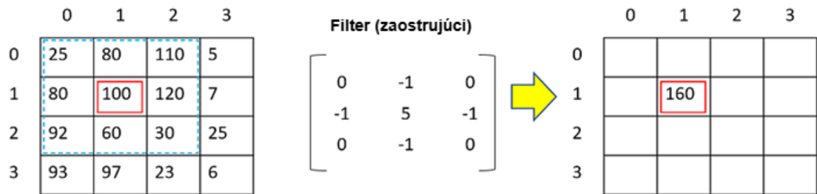
Obrázok 3. Konvolúcia pixelu [1, 1] pomocou zaostrujúceho filtra
