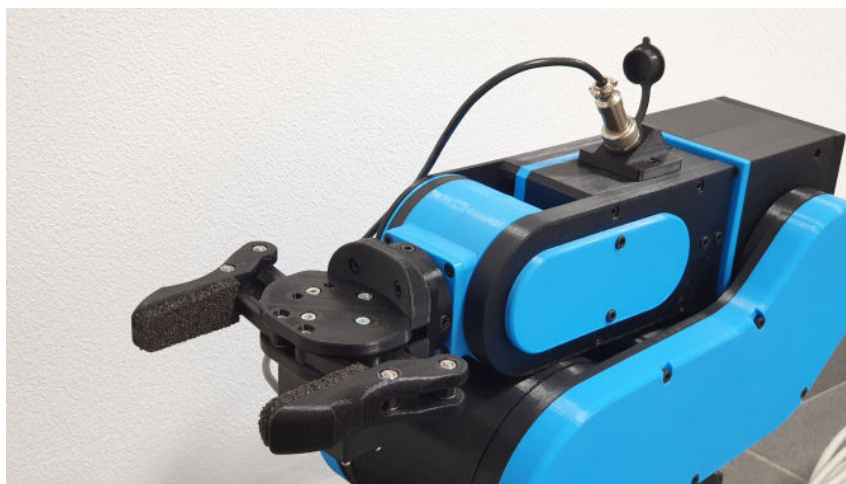
Obrázok 4–7 Robotické rameno s namontovaným úchopným mechanizmom
