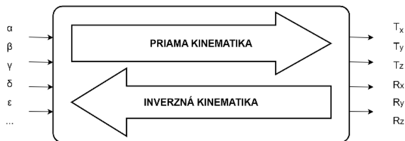
Obrázok 2–1 Schematická reprezentácia priamej a inverznej kinematiky
