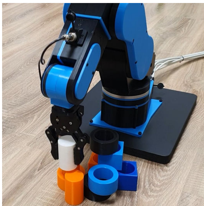
Obrázok 7–2 Ukážka úchopu objektu mechanizmom
