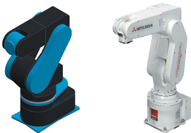
Obrázok 4–2 Porovnanie počiatočného návrhu ramena a priemyselného ramena Mitsubishi
