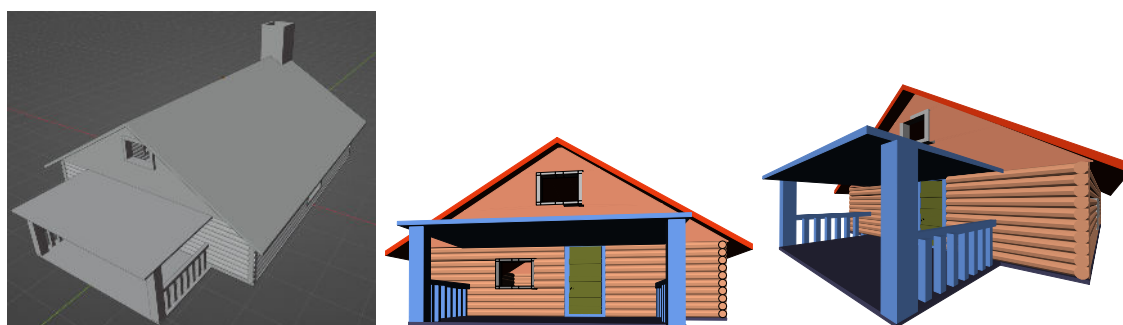
Obrázek 4.2: Ukázka převodu složitějšího modelu domu s aplikací materiálů pro obarvení stěn. Vlevo lze vidět snímek obrazovky s původním modelem v Blenderu, napravo vykreslené výsledné soubory využívající materiály pro obarvení jednotlivých polygonů. Oba výstupní soubory obsahují zhruba 1000 polygonů, mají velikost přibližně 200 kB a jejich převody trvaly přibližně 0,13 sekund.
