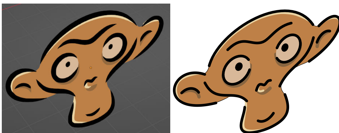
Obrázek 3.45: Ukázka převodu složitějšího objektu Grease Pencil. Nalevo lze vidět původní scénu v Blenderu se složitějším objektem Grease Pencil s více vrstvami a materiály. Napravo lze vidět vykreslení převedeného souboru. Lze si všimnout korektního zachování pořadí vrstev jednotlivých tahů. Proměnlivost intenzity (šířky) čar v jednotlivých částech tahů ovšem není zachována, neboť formát SVG umožňuje pouze konstantní šířku tahu.
