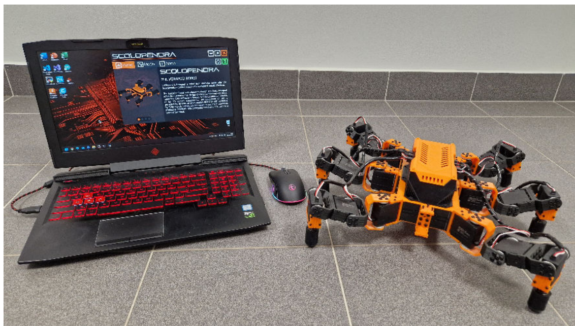
Obrázok 6–6 Pohľad na prepojenú aplikáciu GUI s fyzickým robotom
