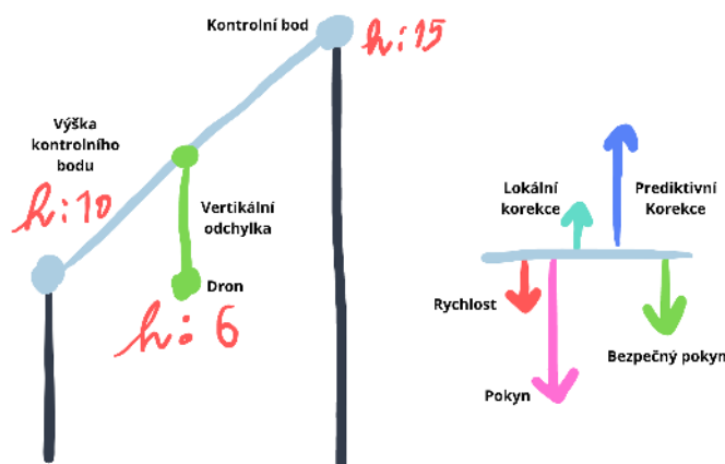
Obrázek 3.9: Pohled z boku - zobrazuje výšku; vpravo pak jsou síly vizualizující vertikální korekci.
