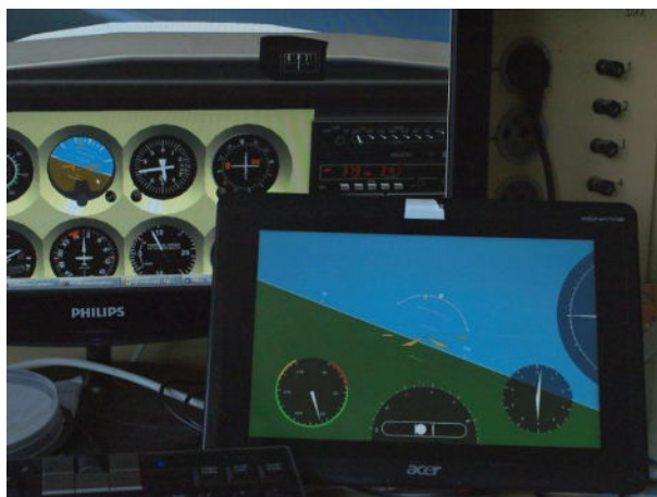
Obrázek 17: Tablet jako zobrazovací zařízení skleněného kokpitu (Levora et al. 2012)
