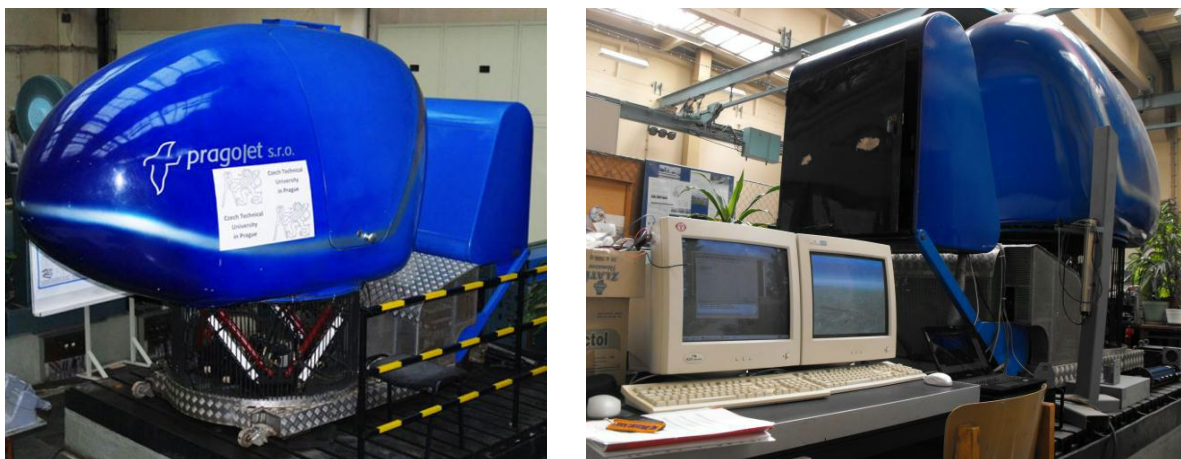
Obrázek 15: Letecký simulátor (vlevo - kabina simulátoru, vpravo - řídící stanice) (OMP seat belts take-off 2011; Bruna et al. 2012)
