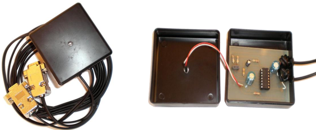
Obrázek 25: Přípravek pro vizuální stimulaci (vlevo - vnější pohled, vpravo - vnitřní uspořádání) (Autor 2012)
