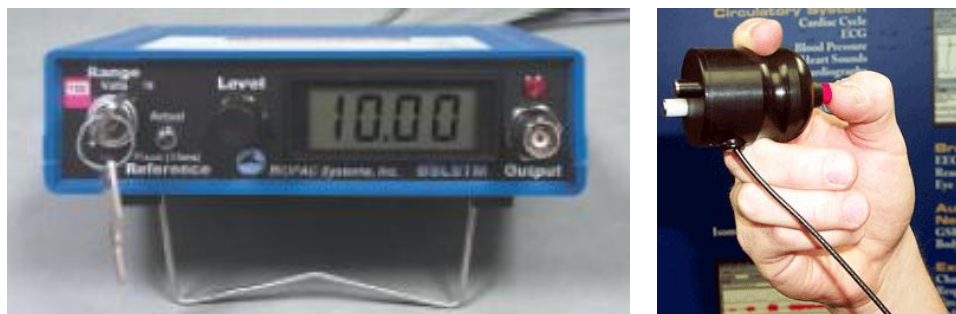
Obrázek 27: Stimulační jednotka (vlevo) a stimulační elektrody (vpravo) (BSL Hardware Guide 2013, s. 14, 103)
