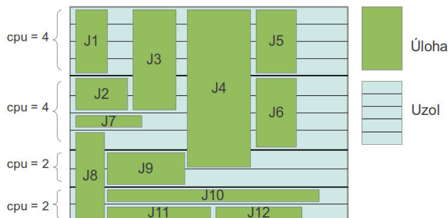
Obrázok č. 13: Rozvrh pre paralelné úlohy vyžadujúce viac výpočtových uzlov.
