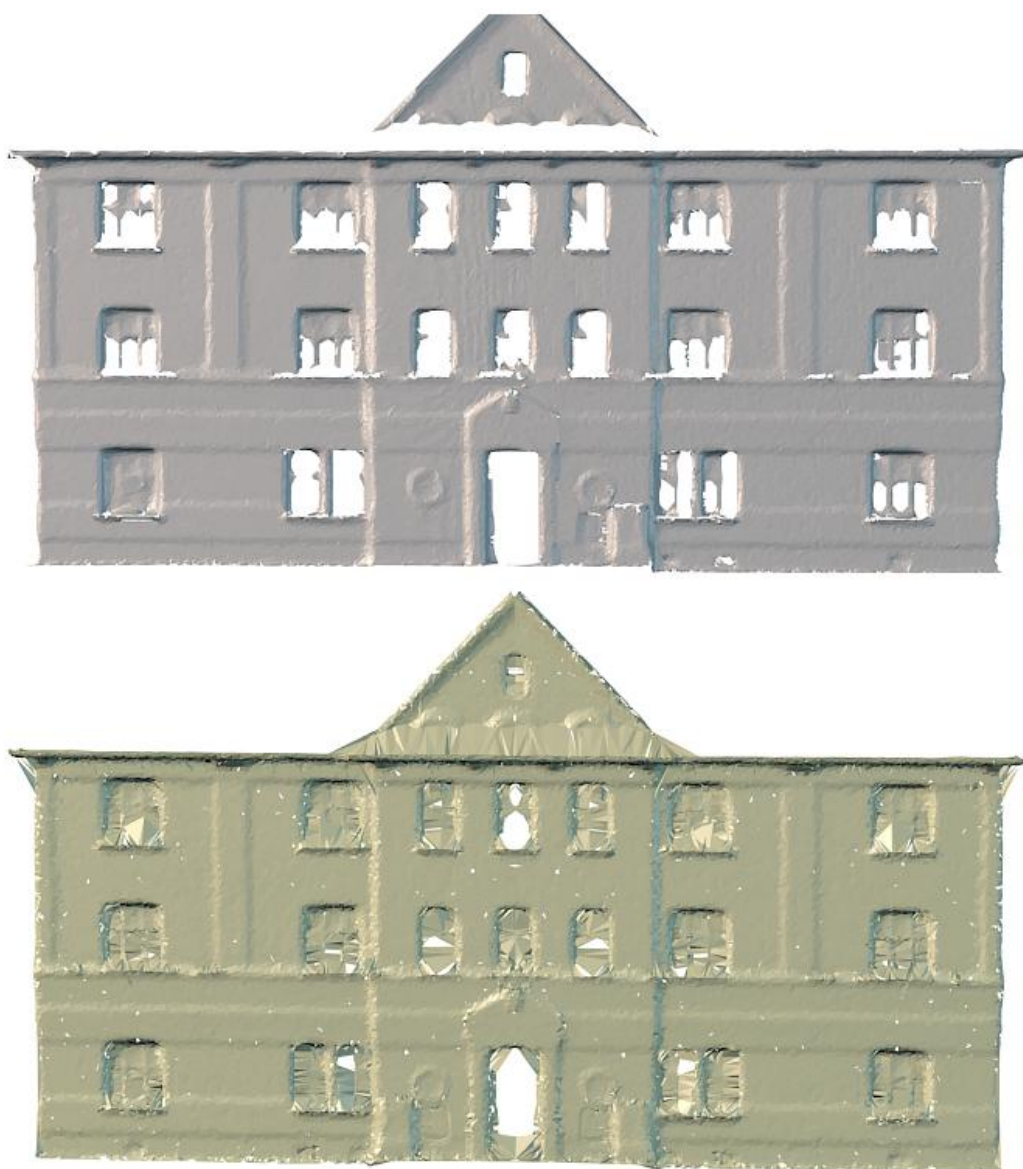
Obr. 27 Porovnanie výstupov z triangulácie 3D skenera (hore) a triangulácie tejto práce (dole)
