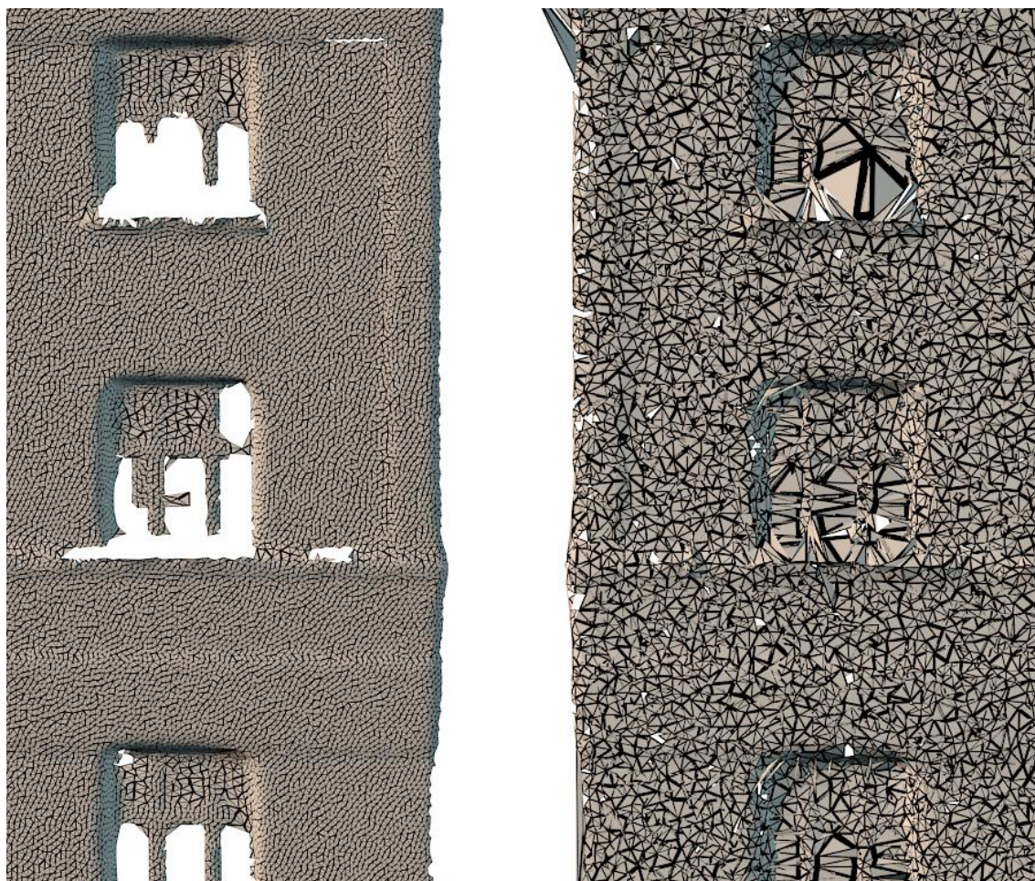
Obr. 28 Bližší pohľad na porovnanie výstupov z triangulácie 3D skenera (vľavo) a triangulácie tejto práce (vpravo)
