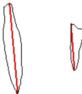
Obrázek 5.4: Nejdelší spojnice dvou bodů obvodu štěrbiny
