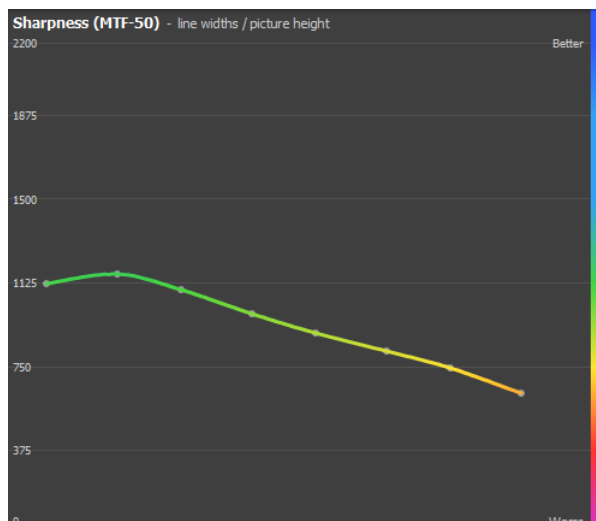
Obrázok 2.20: Rozostrenie Olympusu M. Zuiko Digital 14-150mm F4-5.6: graf znázorňuje ostrosť obrazu v závislosti na pozícii v obraze; prevzaté z www.dpreview.com
