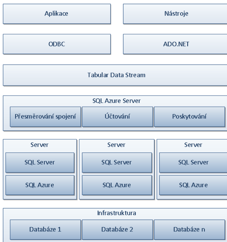
Obrázek 4 - SQL Azure - Fyzická struktura [1]
