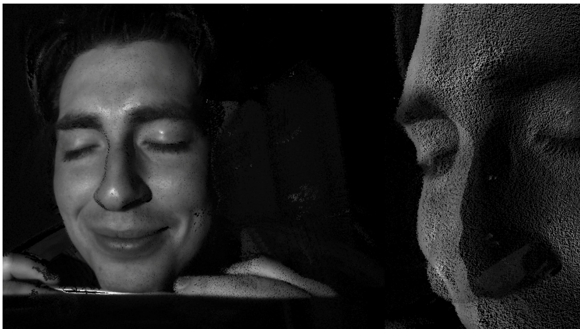
Obrázok 17: 3D mračno bodov získané s použitím 5 kódovaných obrazov
