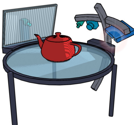
Obrázok 39: Koncept prototypu pre kompletnú 3D rekonštrukciu. Zdroj: Ján Žižka
