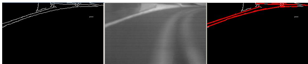
Obrázek 24: Houghova transformace- chybná detekce v zatáčce
