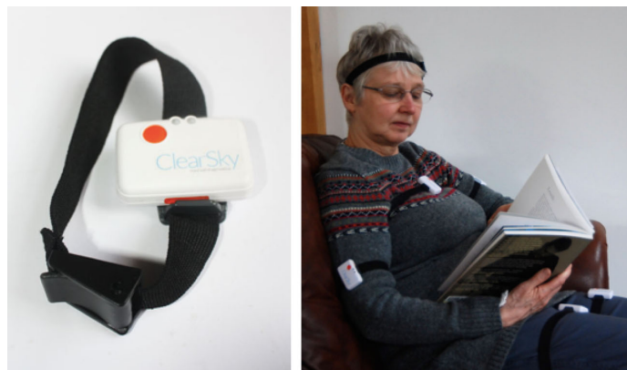
Obrázek 6.1: Ukázka zařízení použitého k zaznamenání pohybových dat společně s příkladem umístění na tělo pacienta. Převzato z [10].
