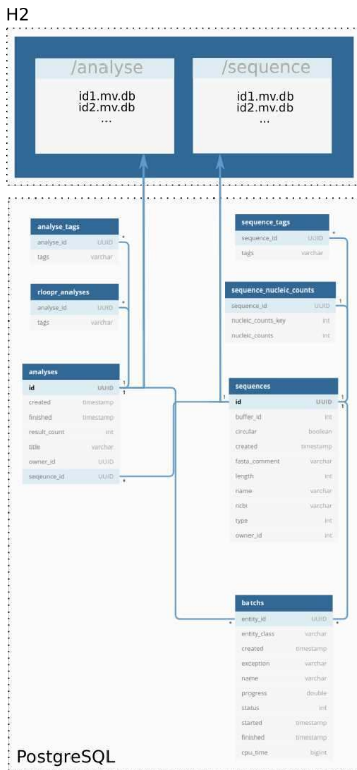
Obrázek 8: Struktura databází pro R-loop-R analýzy. Znázorňuje vztah mezi PostgreSQL a H2 databázovými systémy.
