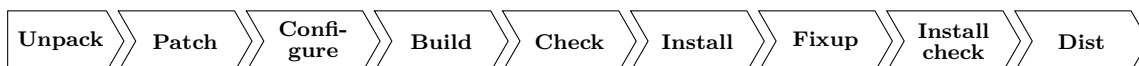
Obrázek 3.4: Fáze standardního sestavovacího skriptu. Fáze jsou vykonávány sekvenčně počínaje fází Unpack a konče fází Dist.
