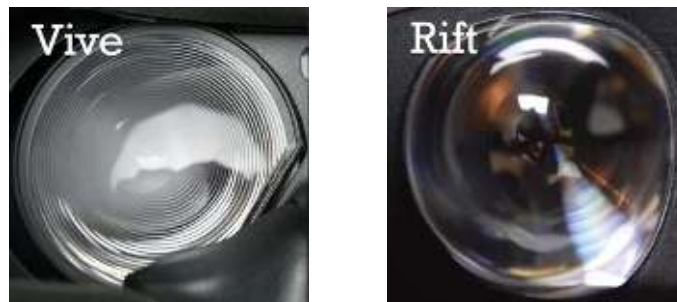
Obr. 7. Klasická Fresnelová šošovka pri pohľade z prednej strany použitá v zariadení HMD HTC Vive [26].
