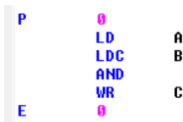
Obrázek 10 Ukázka jazyka IL – součin A a negace B, výsledek zapsán do C
