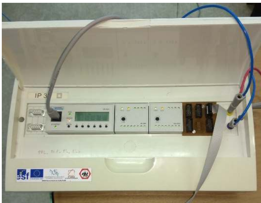
Obrázek 50 PLC Tecomat Foxtrot CP1014 s moduly IB-1301 a OS-1401
