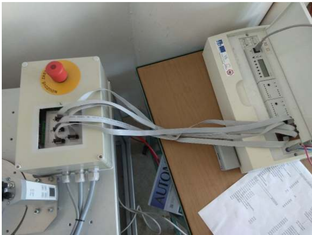
Obrázek 61 Připojené (neukotvené) komunikační rozhraní k PLC Foxtrot
