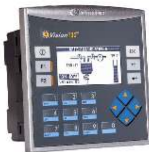
Obrázek 32 PLC Unitronics Vision 130 [25]
