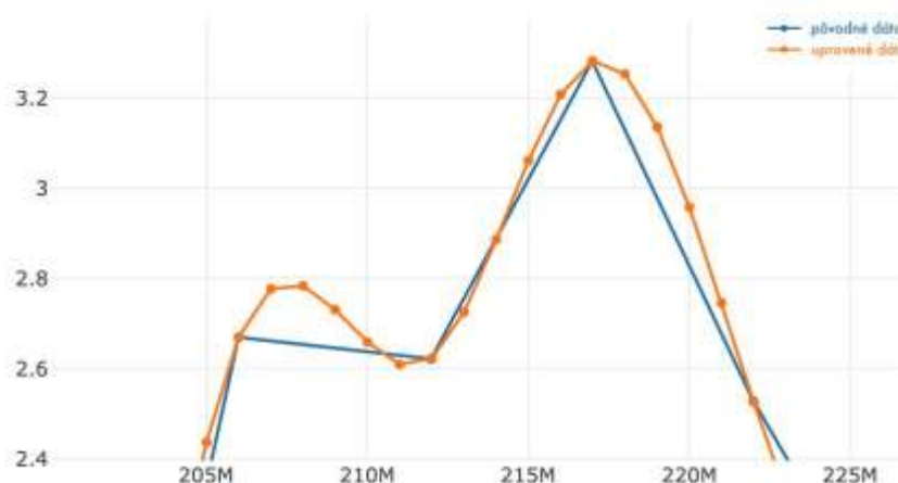
Obr. 12 Interpolácia dát z akcelerometra (konštantná vzorkovacia frekvencia)
