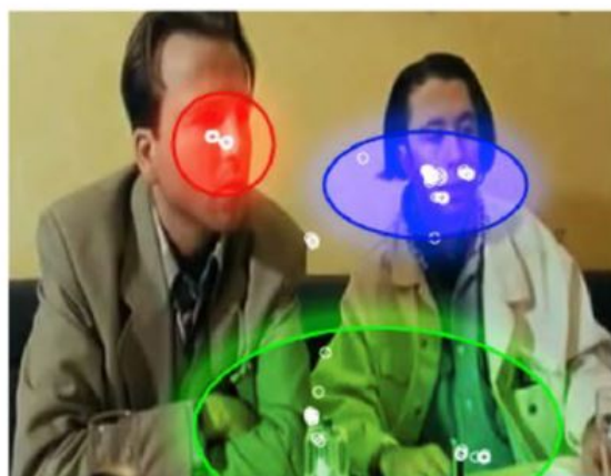
Obr. 2.4: Ukážka Skrytého Markovovho modelu, kde sú skryté stavy (na obrázku červená, modrá a zelená elipsa) reprezentované pomocou dvoj-dimenzionálneho normálneho rozdelenia (obrázok z Coutrot et al. [2017]).
