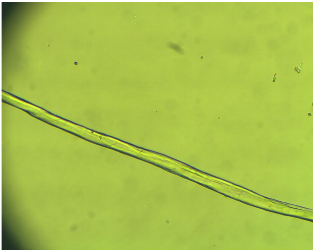
Obrázok 13 - fotografia vlákna polyetylenu pod mikroskopom (zdroj: autor)
