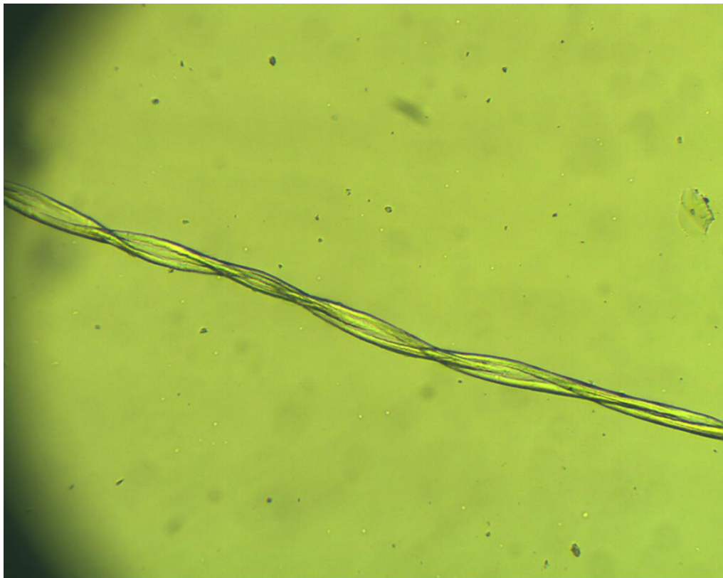
Obrázok 1 - fotografia vlákna bavlny pod mikroskopom (zdroj: autor)
