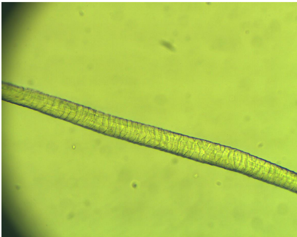
Obrázok 4 - fotografia vlákna vlny pod mikroskopom (zdroj: autor)
