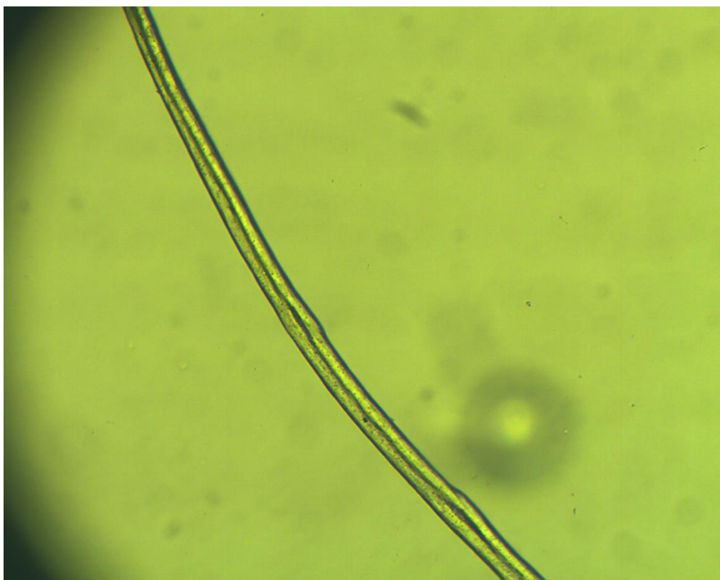
Obrázok 10 - fotografia vlákna etylvinylacetátu pod mikroskopom (zdroj: autor)
