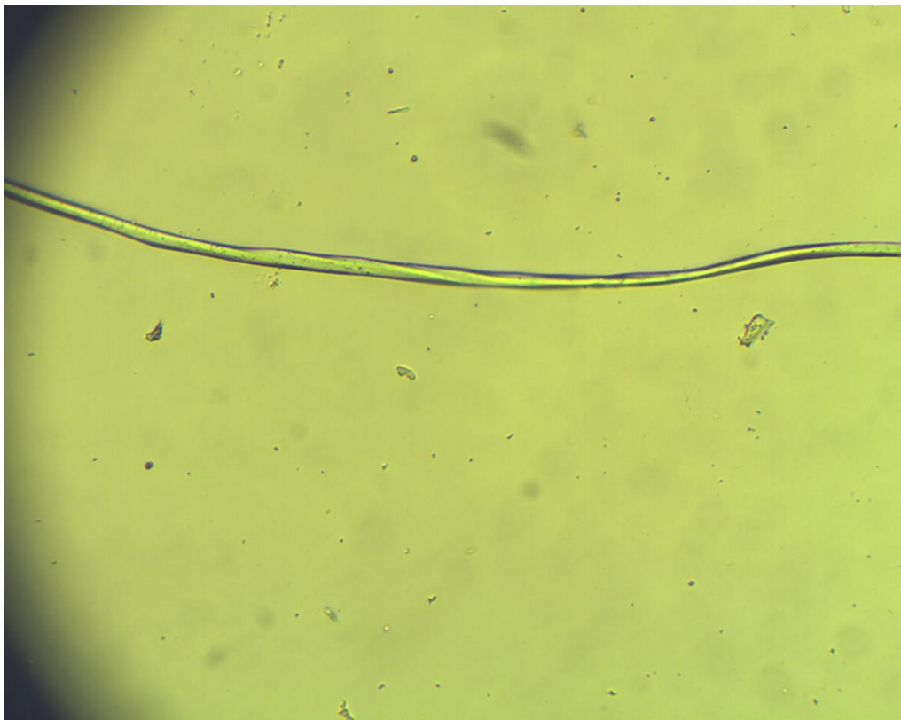
Obrázok 14 - fotografia vlákna polyetyltereftalátu pod mikroskopom (zdroj: autor)
