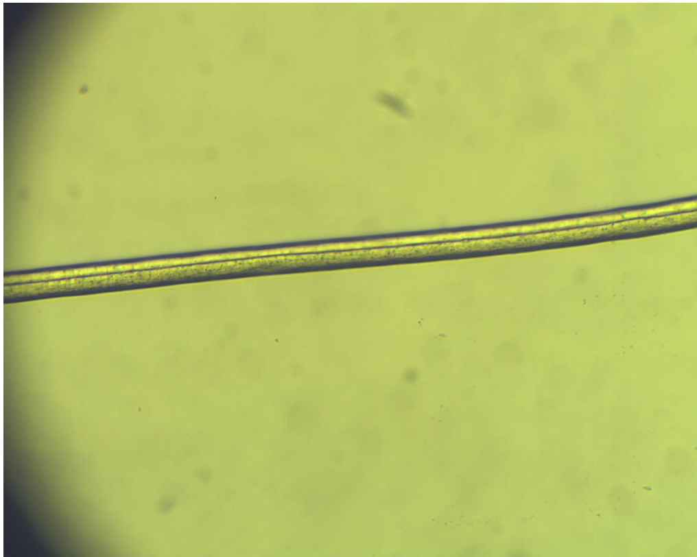
Obrázok 12 - fotografia vlákna polyakrylnitrilu pod mikroskopom (zdroj: autor)
