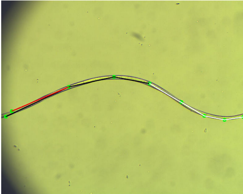
Obrázok 27 – Vlákna (v tomto prípade 3) nájdené programom rozlíšené farbami (zdroj: autor)
