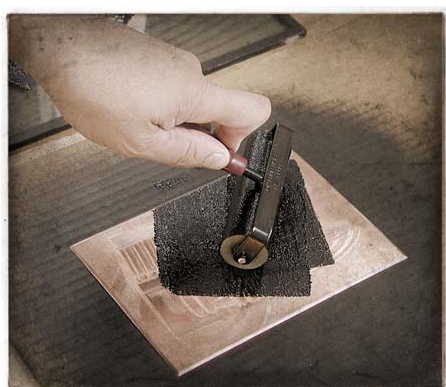
(a) Nanosenie farby pomocou valca.
