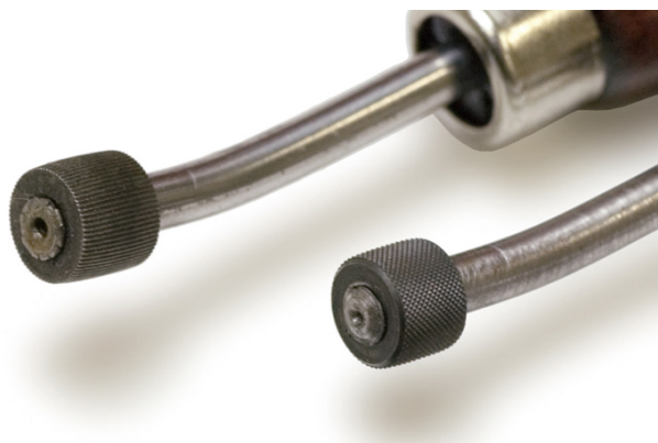
Obr. 2.2: Kotúčové zrníče na vytváranie vzorky po povrchu platne [mez].
