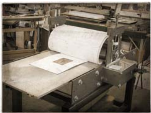
(a) Otláčanie farby pod prítlakovým valcom.
