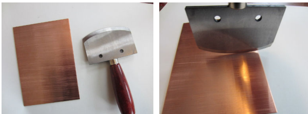
(a) Medená platňa a oceľový polkruhový nôž. (b) Použitie oceľového polkruhového noža.
