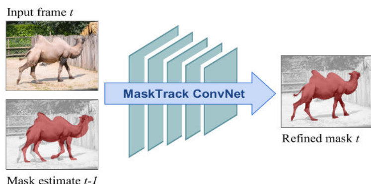
Obr. 3.6: Model je natrénovaný tak, aby dokázal z kombinácie snímky v čase t a segmentačnej masky z predchádzajúcej snímky v čase t - 1 vygenerovať segmentačnú masku pre danú snímku v čase t . Zdroj:[29]
