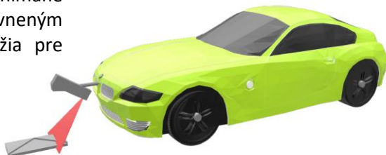
Vozidlo skenujúce profil vozovky so značkou
