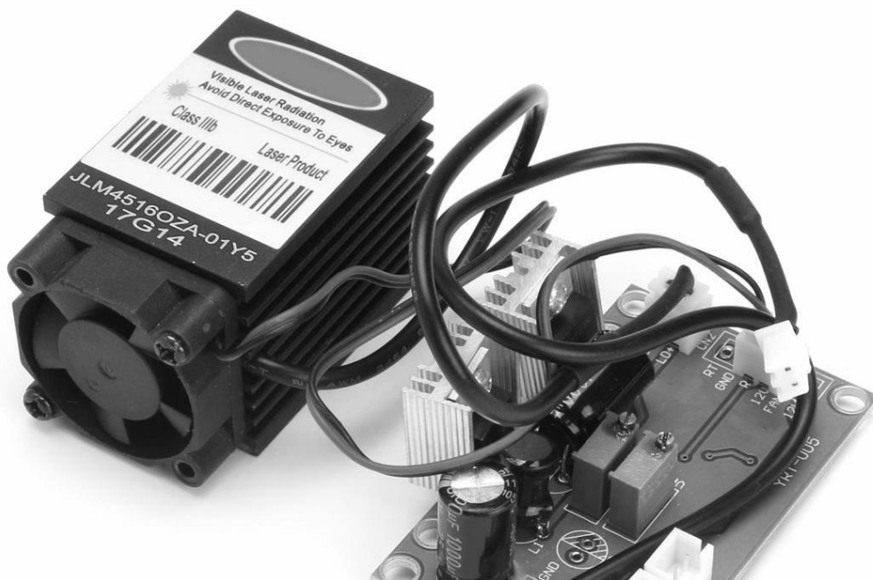
Obrázok 7 2W Laser s ovládacou elektronikou 7
