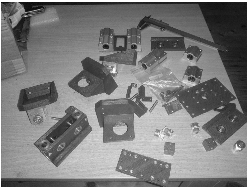
Obrázok 4 Predpripravené súčiastky pre mechanickú časť stroja 4
