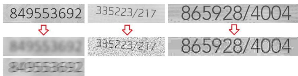
**Obr. 78: Operace Gaussovskeho rozostření (vlevo uprostřed), pohybového rozostření (vlevo dole), přidání šumu (uprostřed) a JPEG komprese (vpravo)**
