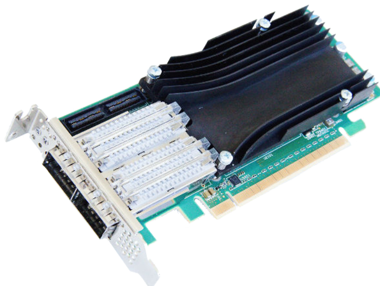
Obr. 4.1: Nízko profilová karta COMBO-200G2QL. Obrázok prevzatý z [21].
