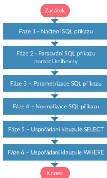
Obrázek 6: Diagram popisující chod modulu
