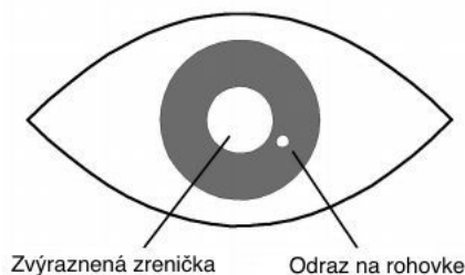
Obr. 1: Zvýraznená zrenička používateľ'a (angl. bright pupil) a odraz na rohovke (angl. corneal reflection) [28]
