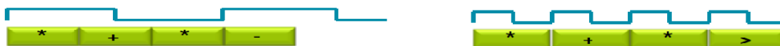
Obr. 2.11: Obrázok obsahuje dva plány operácií pre pomalšiu a rýchlejšiu frekvenciu hodín (prevzaté z [7]).
