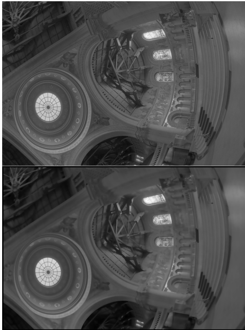
Obr. B.1: Na hornom obrázku sú zobrazené hodnoty intenzít, lineárne namapované do intervalu \langle 0, 255 \rangle . Spodný obrázok je po bilaterálnom filtrovaní. Parametre gaussovej funkcie \sigma_s = 2, \sigma_r = 0.85 . Najlepšie je výsledky vidieť na detailoch stien, kde v prípade bilaterálneho filtru sú rozmazané a v originálnom obraze sú detaily ostré.
