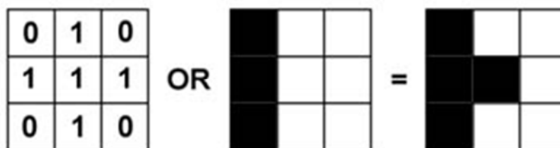
Obrázek 8 - Postup filtrování obrazu dilatací [30]
