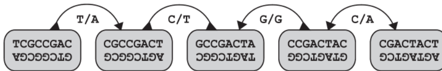
Obr. 13: Obrázok znázotňuje všetky štyri spôsoby, ako môžu byť spojené uzly v dvojito usmernenom k -reťazcovom grafe. Prevzaté z [22].
