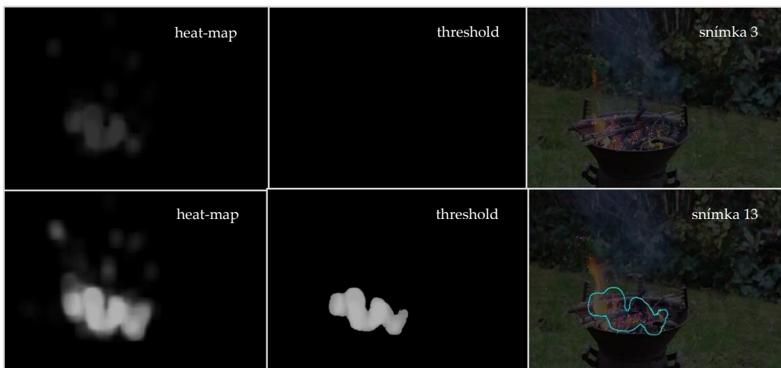
Obr. 3.17: Modelovanie heat-mapy. Vrchný rad reprezentuje stav po získaní troch snímok videa, spodný rad po získaní 13-tich snímok.
