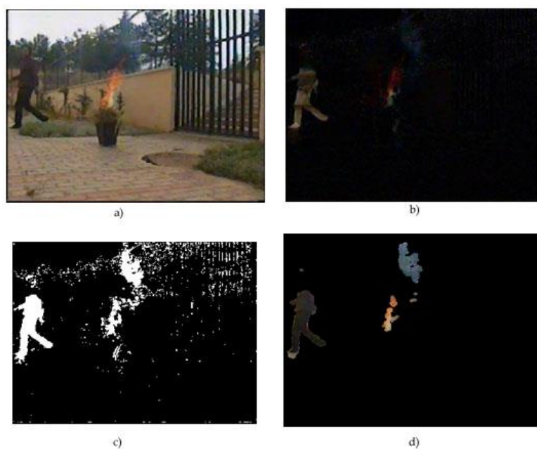
Obr. 3.2: Základné modelovanie pozadia; a) Originálna snímka videa s aplikovaným mediánovým filtrom; b) Rozdiel aktuálnej snímky a modelu pozadia v absolútnej hodnote; c) Prah rozdielu aktuálnej snímky a pozadia; d) Popredie snímky po aplikovaní morfológických operácií na masku popredia
