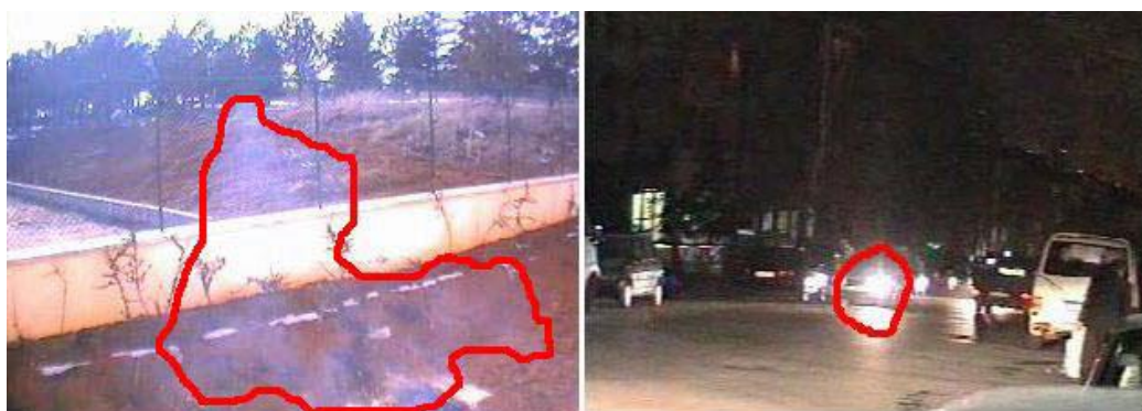
Obr. 2.19: Porovnanie kontúr hraníc segmentovaných oblastí [26]. Na spodnom videu vodič úmyselne mení intenzitu stretávacích svetiel, čím sú splnené požiadavky všetkých charakteristík dymu okrem poslednej predstavenej – kontúry.
