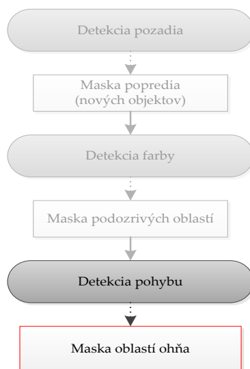
Obr. 3.13: Upravený postup riešenia detekcie ohňa. Použitie detekcie farby a detekcie pozadia je voliteľné.
