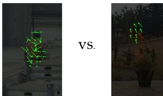
Obr. 3.11: Porovnanie pohybu bežného objektu vľavo s pohybom ohňa vpravo (neideálny prípad)
