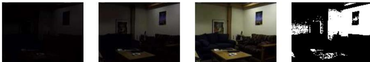
Obr. 2.3: Postupne meniace sa osvetlenie od najslabšieho po najsilnejšie (zľava doprava) a výsledná maska falošného popredia scény získaná štatistickým prístupom detekcie [8]
