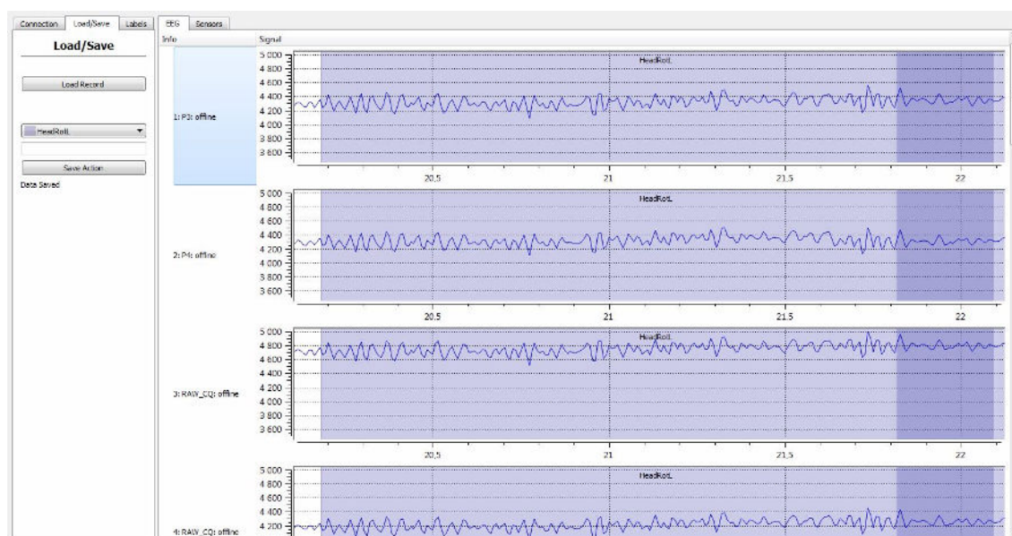
Obrázek 19: Druhá skupina ovládacích prvků, která slouží k označování a ukládání trénovacích vzorků pro jednotlivé akce. Pravá část obsahuje záznam EEG signálu, na kterém se zmíněné vzorky vybírají.
