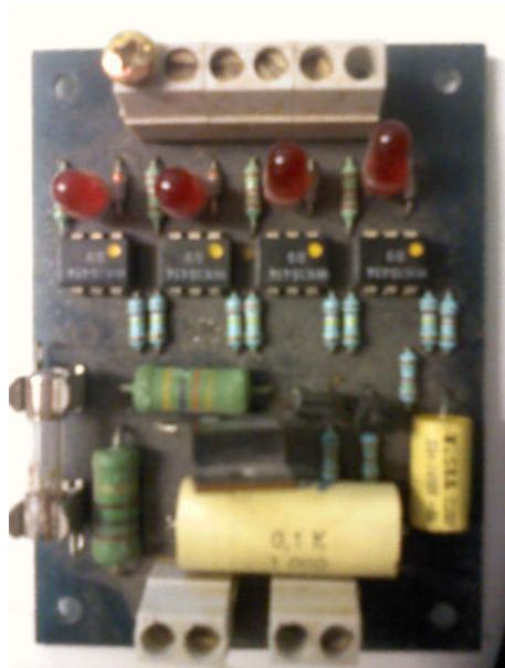
Obr. 4-4 Integrovaný plošný obvod pre vibráciu
