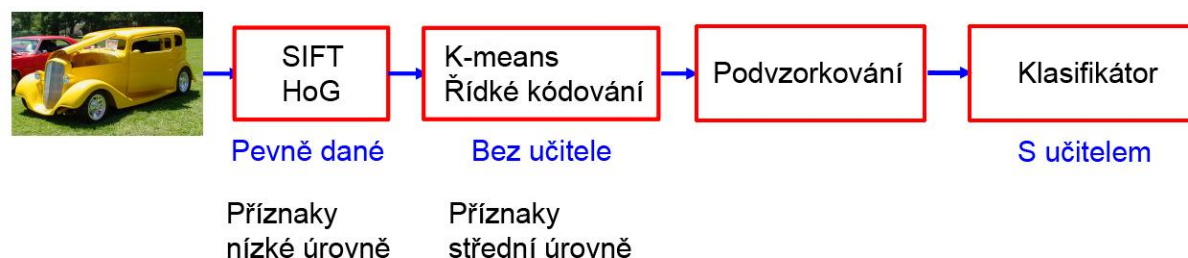
Obrázek 2.8: Podrobné schéma tradičního způsobu klasifikace obrazu [16]
