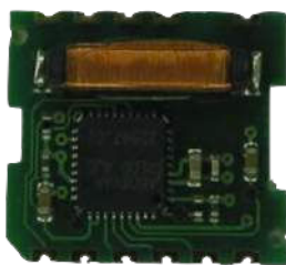
Obr. 22: Vnitřní část čidla RMCM-01 [21]
