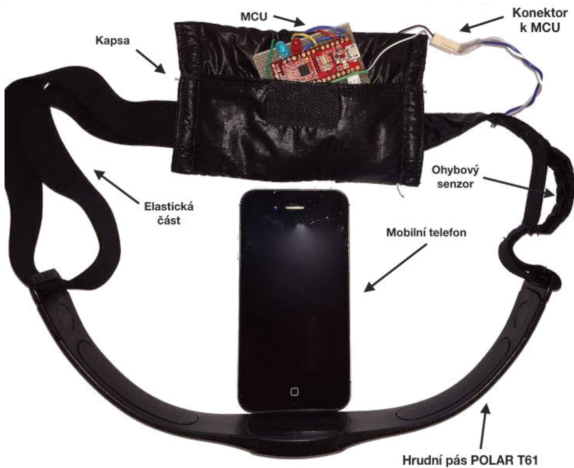
Obr. 25: Kompletní podoba realizace systému
