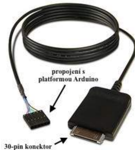
Obr. 17: Sériový kabel Redpark pro TTL komunikaci mezi MT iPhone a platformou Arduino [27]
