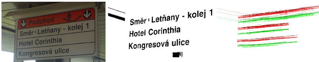
Obrázek 2.7. Vstup (35670 extrémálních oblastí). Vybrané extrémální oblasti (71 kusů). Sestavené trojice (514 kusů, vykresleny pouze dotažnice)
