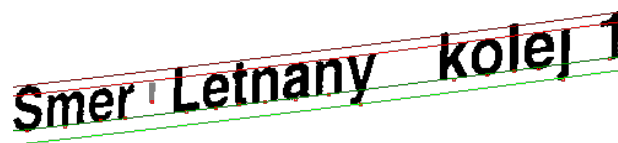
Obrázek 2.8. Oblasti použité k sestavení prototypu (černé a šedivé). Červeno-zelené linky jsou nalezený prototyp. Šedivá oblast (svislá pomlčka) po sestavení prototypu vyloučena, protože nesedí na linkách. Body použité k prokládání směrnice jsou červené čtverečky.
