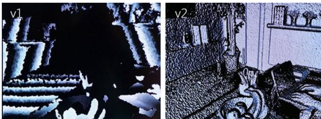
Obr 4. Srovnání hloubkových map Kinectu verze 1 (nalevo) a verze 2 (napravo)
