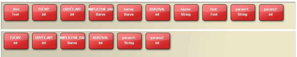
Obr. 12 – Stav zásobníku odkazů při nahrávání instanční metody (nahore) a statické metody (dole)
