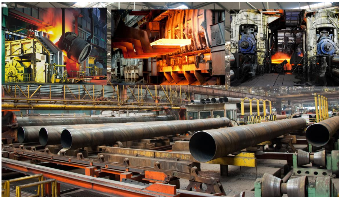
Obr. 15 Odlievanie brám, ich zohriatie a valcovanie a divízny závod Rúrovňa
