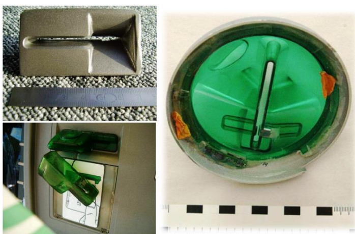
Obrázek 5: Falešné antiskimovací nástavce, zdroj: Policie ČR
