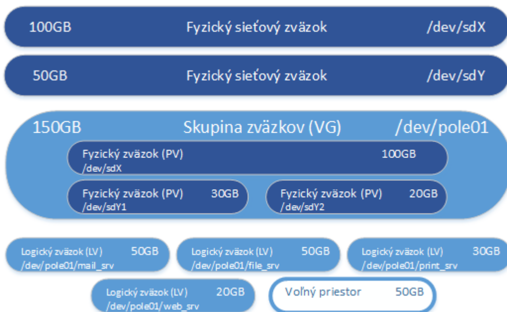
Obrázok 13: Princíp vytvárania zväzkov pomocou LVM (Podľa: [28])
