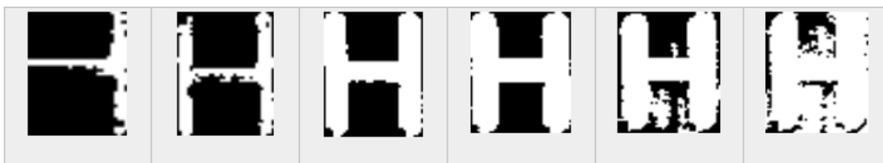
Obr. 39: Ukázka převedení znaku do jednobarevné podoby při použití odlišných hodnot prahu
