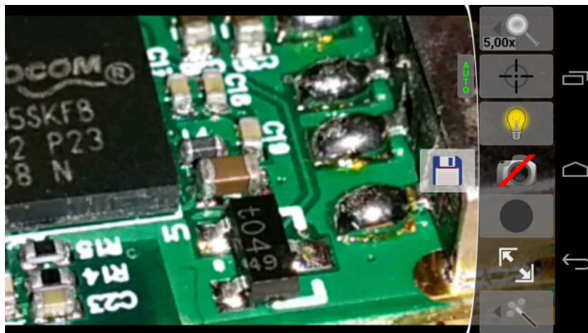
Obrázek 4. Grafické uživatelské rozhraní aplikace Zoomera 2012 po vyfotografování scény s nastaveným digitálním zoom na 5x, rozsvícenou LED, povoleným kontinuálním ostřením.
