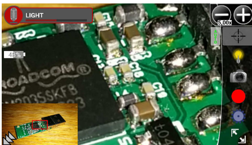
Obrázek 55. Grafické uživatelské rozhraní se zapnutým hlasovým ovládáním. Obrázek ukazuje situaci při hlasovém zadání příkazu pro rozsvícení LED.
