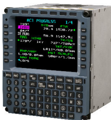
Obrázek 1.5: Flight Management System používaný v moderních letadlech [8]
