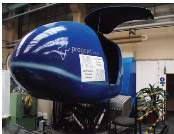
Obr. 2.3: Reálný snímek kabiny simulátoru na pohyblivé základně.
